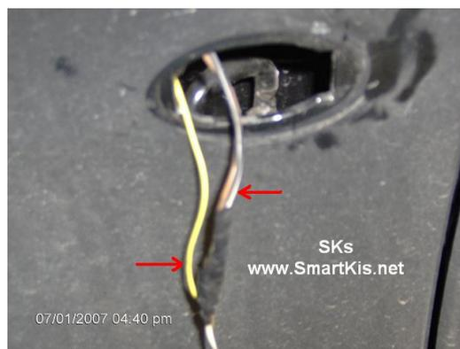
Posizionare il filo giallo della centralina SKs nel passa cavi della portiera fino al vano della freccia. Collegare il filo giallo al positivo della freccia, il filo marrone è il negativo
