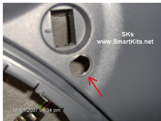
Sganciare il pulsante lato guida e forare il pannello guida con una fresa da 22 mm per posizionare il nuovo pulsante.
