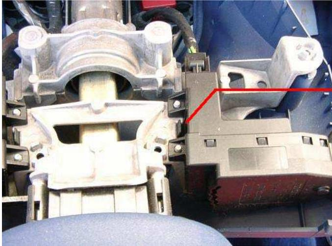
**Rimuovere la leva del tergicristallo facendo leva sulla linguetta ed installare la leva del cruise control.**
