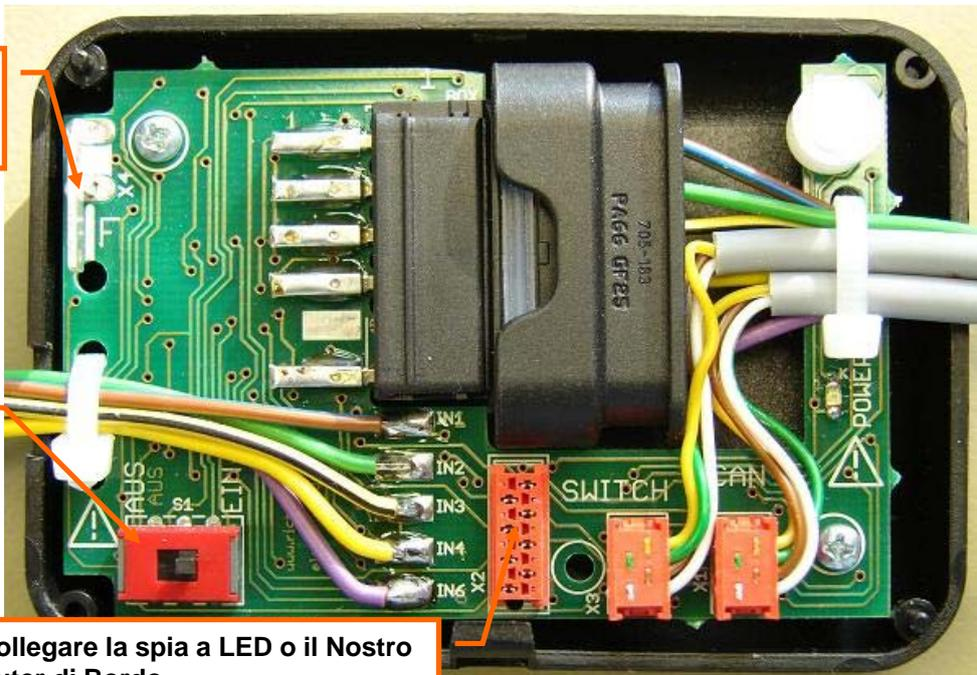
Connettore del segnale di velocità per il navigatore
